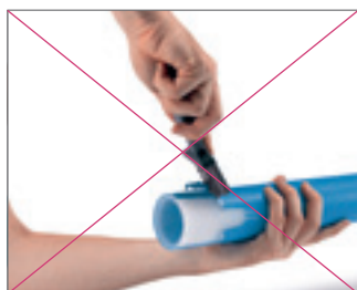
Рис. 69 Не удаляйте верхний слой за пределами отметок
