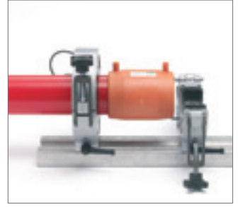
Рис. 98 Устройство для фиксации трубы установить как можно ближе к электросварной муфте FUSAPEX
