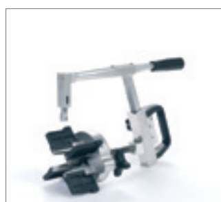
Рис. 92 Для зачистки трубы использовать специальное устройство
