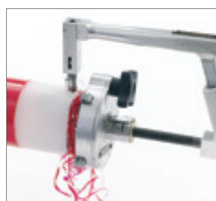
Рис. 93 Производить зачистку трубы дважды
