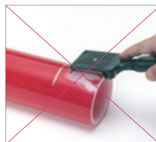
Рис. 124 Не зачищайте трубы шабером, используйте его только для доработки. Всегда используйте устройство для зачистки трубы
