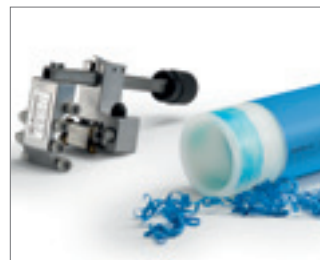
Рис. 68 Если используется автоматическое устройство для снятия верхнего слоя трубы, то его следует прогнать только один раз. Остатки цветного слоя не влияют на процесс сварки, если был удален верхний слой
