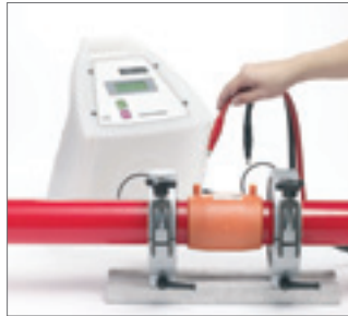
Рис. 104 Звуковой сигнал срабатывает после завершения процесса сварки. На дисплее появляется сообщение «OK». Штекерные разъемы можно вынуть
