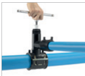
Рис. 61 9. После завершения гидравлического испытания торцовым ключом на 12 завернуть фрезу в тело трубы
