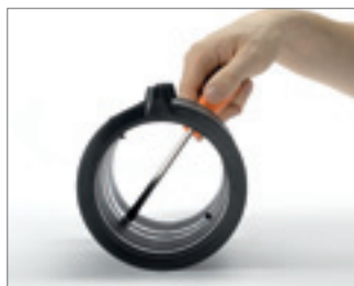
Рис. 77 Если муфта используется в качестве подвижной, то из нее следует удалить упорный ниппель
