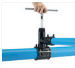
Рис. 62 10. После завершения вырезания отверстия в трубопроводе вывернуть фрезу, вращая ее до упора против часовой стрелки
