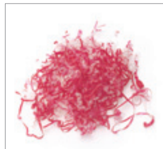
Рис. 112 При зачистке трубы должна возникать длинная и равномерная стружка (от 0,1 до 0,2 мм); при необходимости заменить устройство для зачистки
