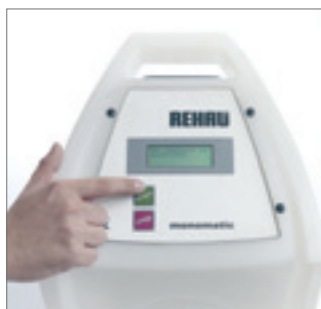
Рис. 50 12. Повторное нажатие на кнопку пуска запускает процесс сварки
