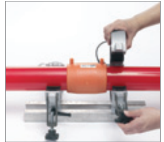
Рис. 106 После периода охлаждения, указанного на фитинге, можно демонтировать устройство для фиксации трубы
