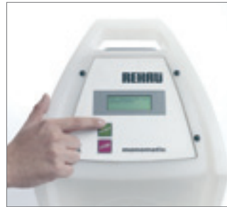
Рис. 101 Нажать кнопку пуска на сварочном аппарате. Параметры сварки на дисплее должны совпадать со значениями на электросварном фитинге FUSAPEX
