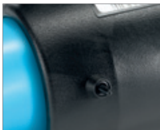
Рис. 78 В приваренных электросварных муфтах индикаторные стержни приподнимутся со стороны обоих концов трубопровода
