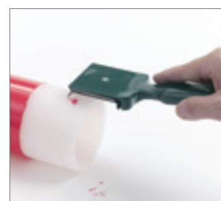
Рис. 94 Остатки краски необходимо полностью удалить шабром
