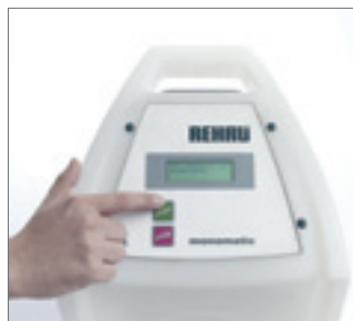
Рис. 58 6. Начать процесс сварки нажатием кнопки «Старт»
