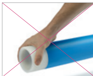
Рис. 71 К зоне сварки нельзя прикасаться руками
