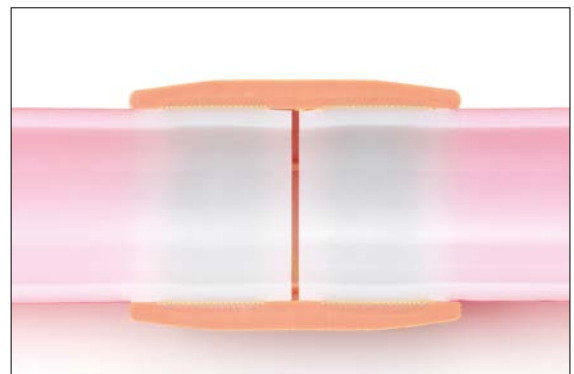
Elektroschweißmuffe FUSAPEX im Schnitt
