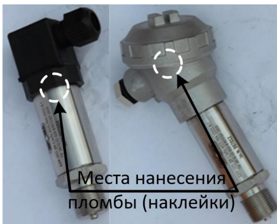
Рисунок 2 – Схема пломбировки от несанкционированного доступа
