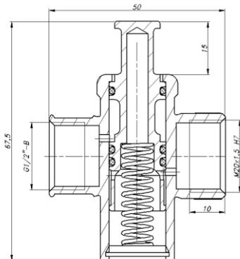
3.1 Кран кнопочный для манометров широко используются в тепло- и газораспределительных пунктах, а также, в других необслуживаемых (или периодически обслуживаемых) помещениях.
