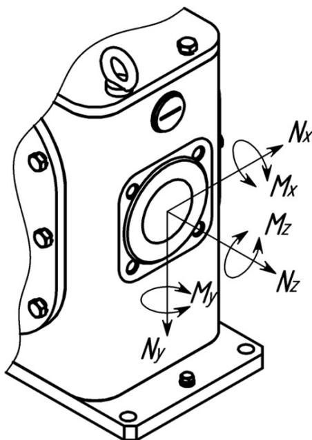
Рисунок 1 - Схема усилий и моментов
