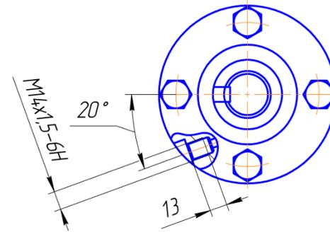
Рисунок А.2 – Торцовое уплотнение со вспомогательным уплотнением (остальное см. рисунок А.1)
