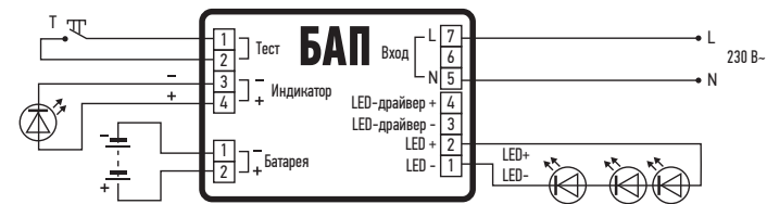
Рисунок 2. PEPP40-1.0H IP20. Непостоянный режим
