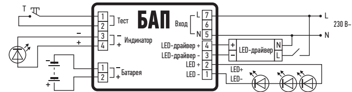
Рисунок 3. PEPP40-1.0H IP20. Постоянный режим.
