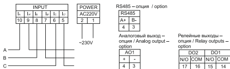
a) схема подключения 3-ф. амперметра при I \leq 5 A / connection diagram of 3-ph. ammeter at I \leq 5 A
