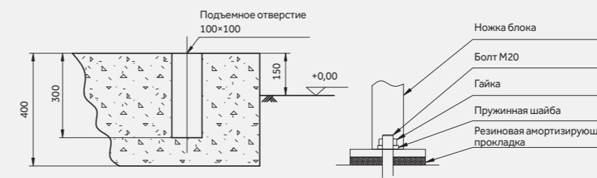
Схема подготовленного квадратного отверстия в основании
