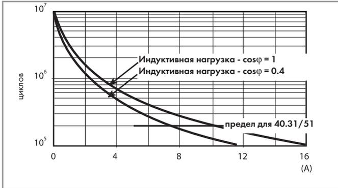
**F 40 - Электрическая долговечность (АС) при номинальной нагрузке**
