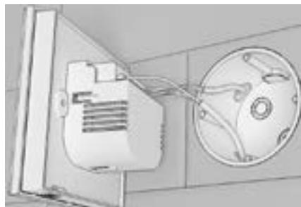
1. Подведите провода в монтажную коробку в соответствии с электрической схемой подключения регулятора.
