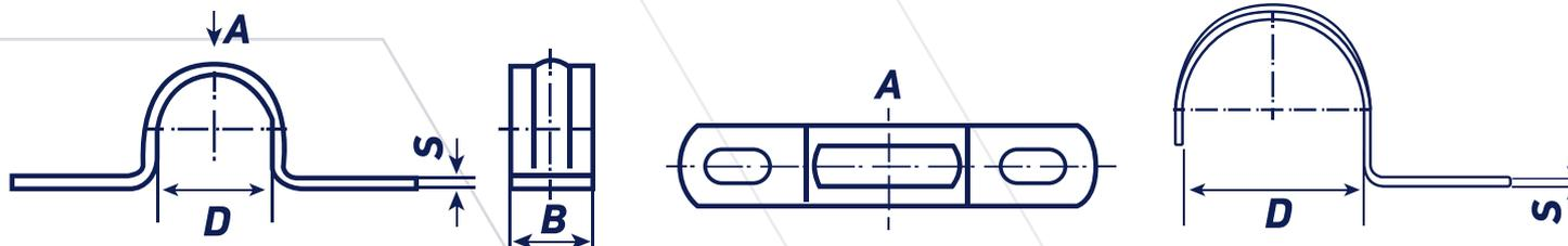
СКОБЫ МЕТАЛЛИЧЕСКИЕ ПРИМЕНЯЮТСЯ ДЛЯ ПРОКЛАДКИ МЕТАЛЛУКАВОВ, КРЕПЛЕНИЯ ТРУБ И КАБЕЛЕЙ К РАЗЛИЧНЫМ ПОВЕРХНОСТЯМ С ПОМОЩЬЮ ВИНТОВ, ШУРУПОВ И Т.П.
