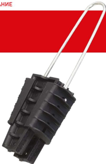
Зажим анкерный клиновой PA25x100 предназначен для крепления абонентской линии из 2 или 4 проводов. Специальный рельеф поверхности клиньев надежно фиксирует проводник, не повреждая при этом изоляцию. Легкий монтаж без использования инструмента. Увеличенная до 350 кгс разрушающая нагрузка позволяет монтировать пролеты до 40 м.
