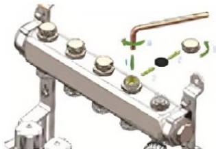
Рисунок 5 - Настройка запорно-балансировочного клапана КГ
