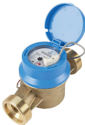
ОСВХ-40 «НЕПТУН» Класс «С» ДГ 1 (10 л/имп) счетчик крыльчатый одноструйный холодной воды метрологического класса «С»
