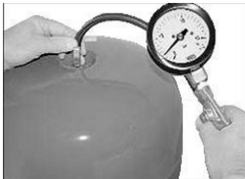
Рис. 6 Контроль давления в мембранном баке
