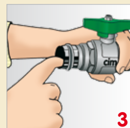
Verificare che l'O-ring di tenuta sia posizionato nella sua sede. Non occorre lubrificazione. Check that the tightening O-ring is placed correctly. Do not oil or grease the tightening O-ring.
