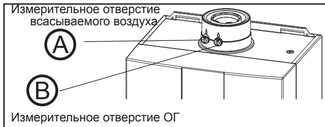
Рисунок: Измерение параметров отработавших газов
