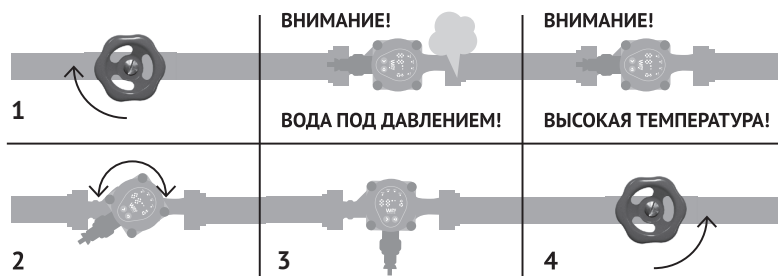
Рисунок 4. Порядок изменения положения блока управления
