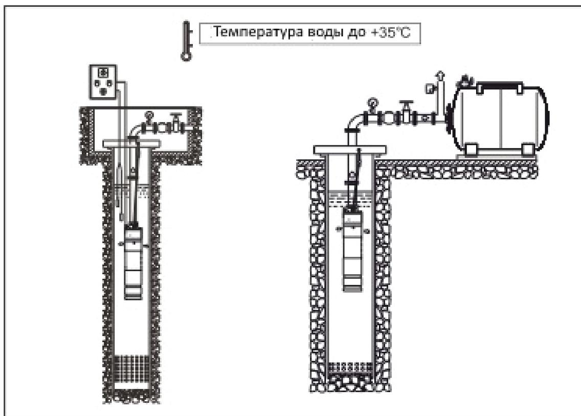
Погружной винтовой насос является важным оборудованием для подъема воды с повышенным содержанием песка, глины и других мелких механических загрязнений из скважин диаметром от 100 (76 для SBO-0,5-80) мм и более из глубоких скважин, а также, **при использовании охлаждающего кожуха**, колодцев, накопительных емкостей, рек, прудов и т.д. При эксплуатации блок должен быть полностью погружен в воду.
