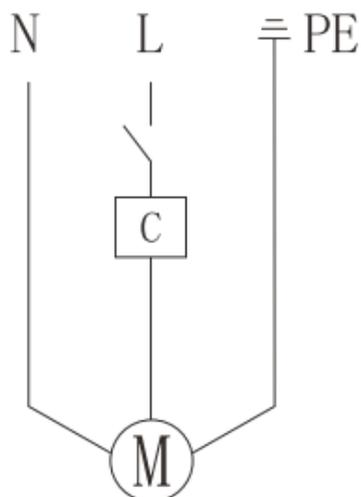
Подключение электродвигателя со встроенным пусковым конденсатором
