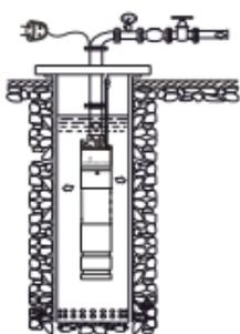
Перед покупкой и установкой насоса проверьте, соответствует ли внутренний диаметр скважины минимальному диаметру скважинного насоса. Необходимо убедиться в наличии достаточного зазора (не менее 5 мм с обеих сторон) между корпусом скважинного насоса и стенкой обсадной трубы, а также в отсутствии ее деформаций и повреждений, выступов, наплывов и т.д. При работе двигателя, который охлаждается водой, следите за уровнем жидкости согласно инструкциям производителя.
