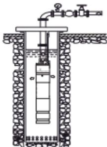
Чтобы установить электрический насос в пруду, необходимо поднять его с помощью штатива или при помощи лодки, моста или причала. Не размещать его прямо на дне реки, иначе двигатель может постепенно застревать в грязи, что приведёт к блокировке вала насоса, ухудшению теплоотвода и последующему выгоранию обмоток электродвигателя.
