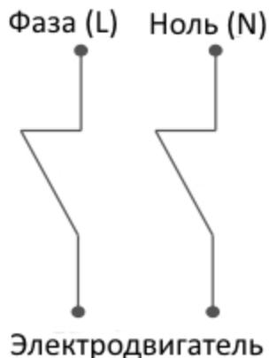
При прямом включении (величина рабочего тока насоса не должна превышать 10 А), питание (220 В) подается на группу контактов А-В, насос же подключается к группе контактов С-Д (или наоборот). Подключение заземления обязательно!
