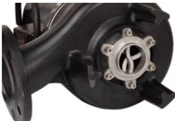
Рис.2 Система измельчения SL с неподвижным ножом.
