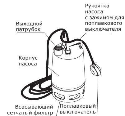
Рис. 1 Конструкция насосов APV.06 / APV.40 V
