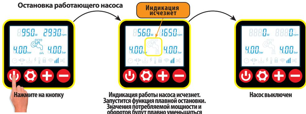
– если в момент выключения насоса перекачка воды не осуществлялась - насос выключится сразу, исключая функцию плавной остановки.
