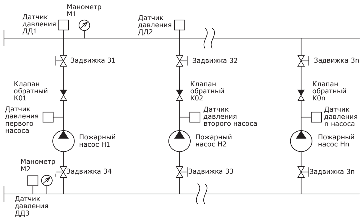
Рис. 3 Общая принципиальная схема установки Hydro-FS-V
