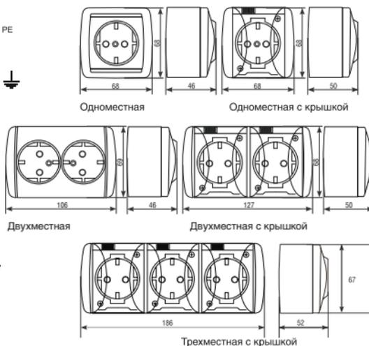
Рис. 2 Габаритные размеры, мм
