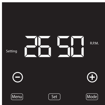
Рисунок 20 – Установка скорости в режиме самозапуска
