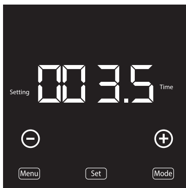
Рисунок 19 – Установка времени в режиме самозапуска
