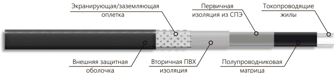
SRM-\_\_-2CR - Конструкция с оболочкой из термопластичного эластомера поверх оплетки обеспечивает дополнительную защиту и может использоваться в системах, содержащих слабые растворы неорганических веществ.
