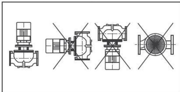
Для мощности  $\geq 5,5$  кВт
