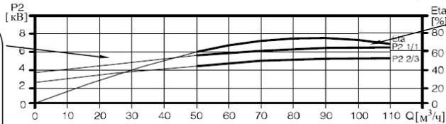
Кривая ЕТА показывает КПД насоса с обычными колесами. КПД насосов уменьшенного диаметра примерно на 2% ниже, чем эта кривая, показанная на графике
