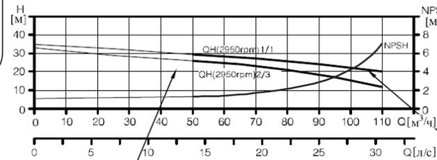
Кривая NPSH показывает усредненную характеристику для всех исполнения насоса при выборе следует добавить запас прочности не менее 0,5 м
