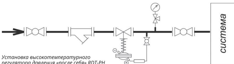
Установка высокотемпературного регулятора давления «после себя» RDT-PH
