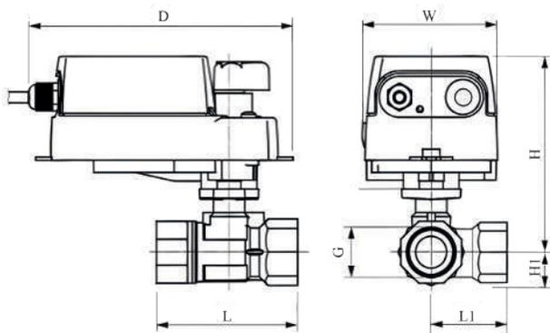
Таблица 3.1.3 Габаритные размеры и масса регулирующих кранов шаровых с электроприводом TBV
