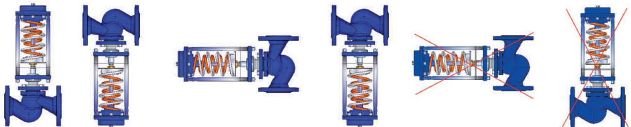
Монтажные положения регулятора на трубопроводе при температуре среды до 120°C.
