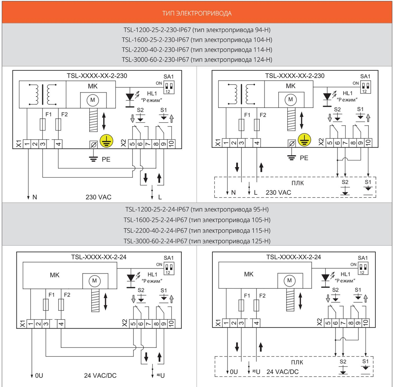
Таблица 2.5.9 Схема подключения электроприводов TSL с аналоговым управлением
