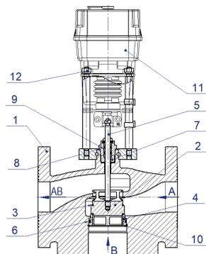
Устройство трехходового регулирующего
