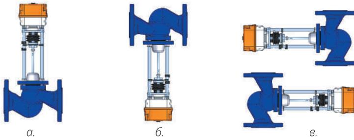
Монтажные положения регулирующего клапана:
