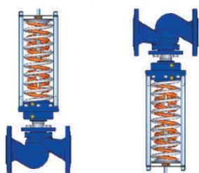
Монтажные положения регулятора на трубопроводе при температуре среды до 120°C.
