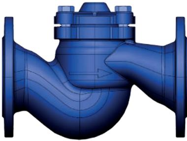
Клапаны устанавливаются на горизонтальных участках трубопроводов крышкой вверх с направлением среды соответствующим направлению стрелки на корпусе.
