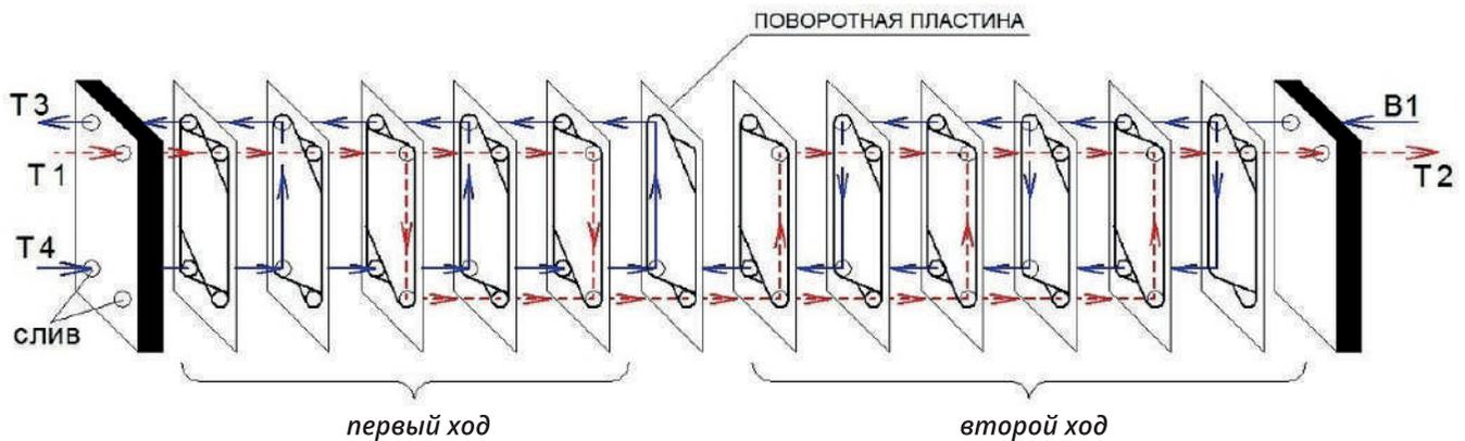
Греющий теплоноситель, поступающий в двухходовой теплообменник через порт Т1, движется по четным каналам (начиная со второго канала) сверху вниз. По прохождению первого хода теплоноситель, упираясь в поворотную пластину, меняет направление своего движения и движется снизу вверх. Пройдя второй ход, теплоноситель уходит через порт Т2. Нагреваемый теплоноситель движется противотоком по отношению к греющему теплоносителю.
