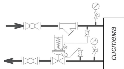
Установка регулятора перепада давления на обратном трубопроводе
