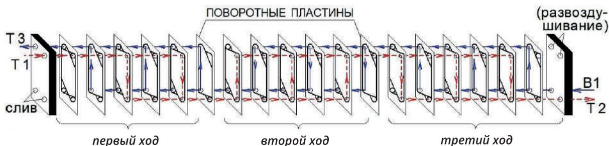
Греющий теплоноситель, поступающий в трехходовой теплообменник через порт T1, движется по четным каналам (начиная со второго канала) сверху вниз. По прохождению первого хода теплоноситель, упираясь в поворотную пластину, меняет направление своего движения и движется снизу вверх. По прохождению второго хода теплоноситель, упираясь в очередную поворотную пластину, меняет направление своего движения и движется сверху вниз. Пройдя третий ход, теплоноситель уходит через порт T2.
