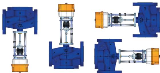
Монтажные положения клапана с электроприводом.
