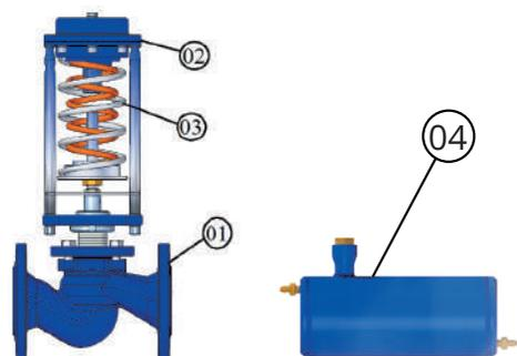
Общая конструкция высокотемпературного регулятора давления состоит из четырех главных элементов:
