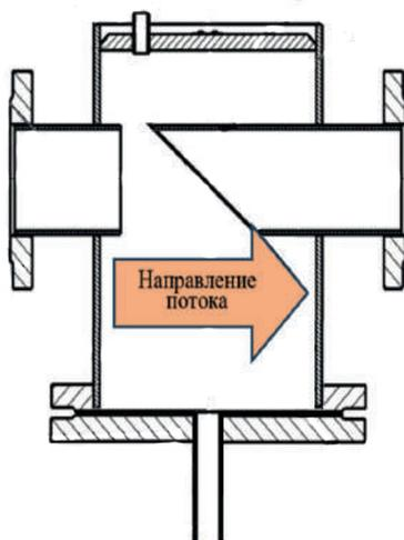
Монтажные положения грязевика вертикального ТГВА. Направление потока – по стрелке (размещена на табличке), улавливающей камерой вниз.
