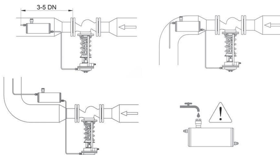
Варианты подключения охладителя импульса высокотемпературного регулятора давления «после себя» RDT-PH
