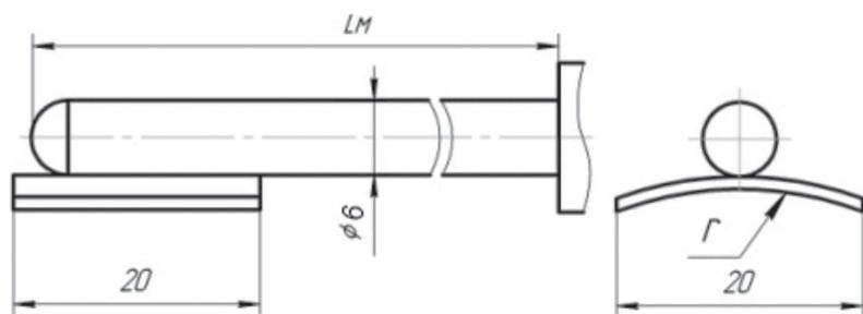
Датчики данного типа предназначены для измерения температуры поверхности твердых тел контактным методом.
