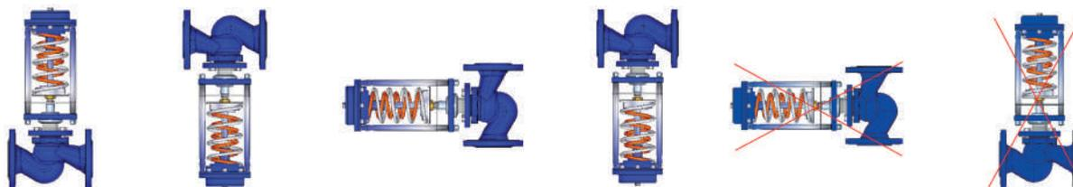
Монтажные положения регулятора на трубопроводе при температуре среды до 120°C.
