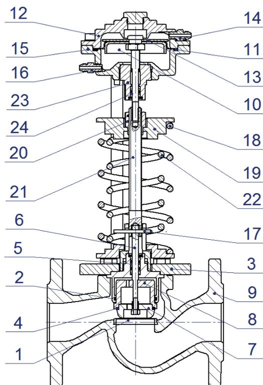
Устройство высокотемпературного регулятора давления
