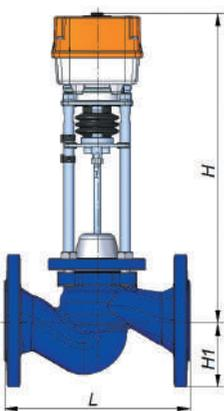
Таблица 2.1.4 Габаритные размеры и масса двухходового регулирующего клапана TRV
