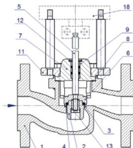
1. Корпус клапана
