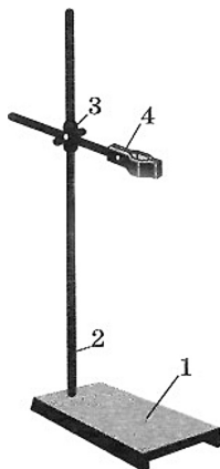
Рис. В.3 Штатив лабораторный 1 - подставка 2 - стержень 3 - муфта 4 - лапка
