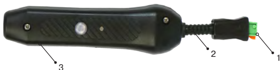
Рис.А.7 Смарт-зонд подключения внешней термопары (СЗВТ, СЗВТП)
