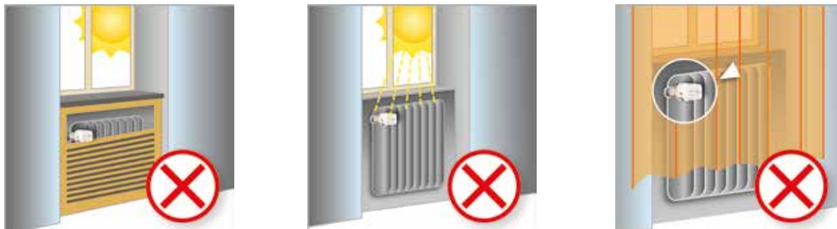
Рис. 7.10. Требования по размещению автоматического терморегулятора
