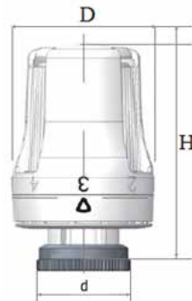
Рис. 7.6. Габаритные и присоединительные размеры термоголовки Арт. SHT 0002 003015
