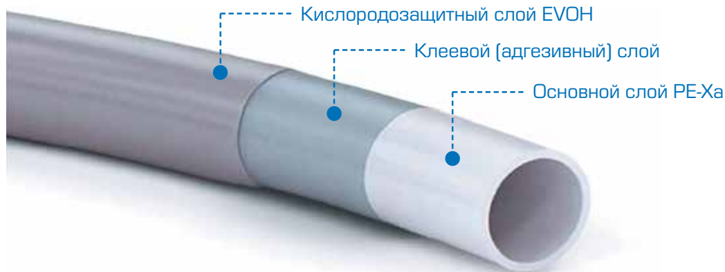
Рис. 2.1. Трехслойная труба РЕ-Ха/EVONH
