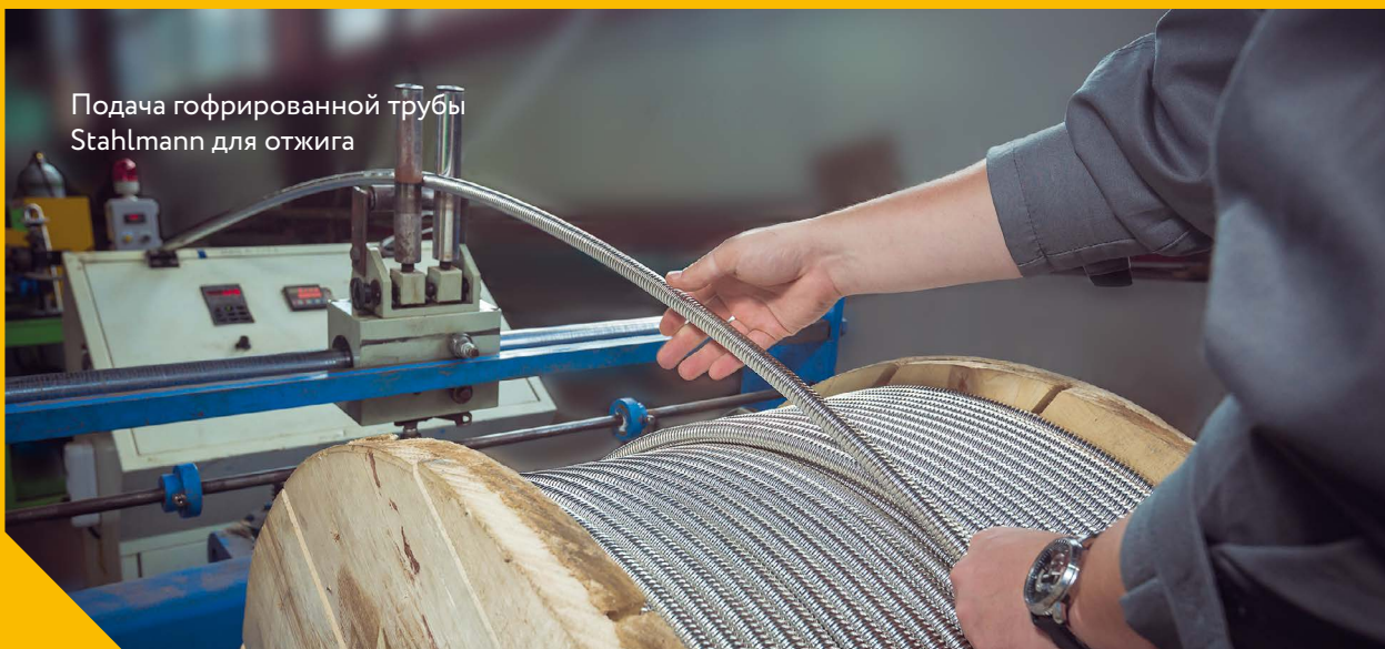
Линия охлаждения гофрированной трубы Stahlmann после отжига
