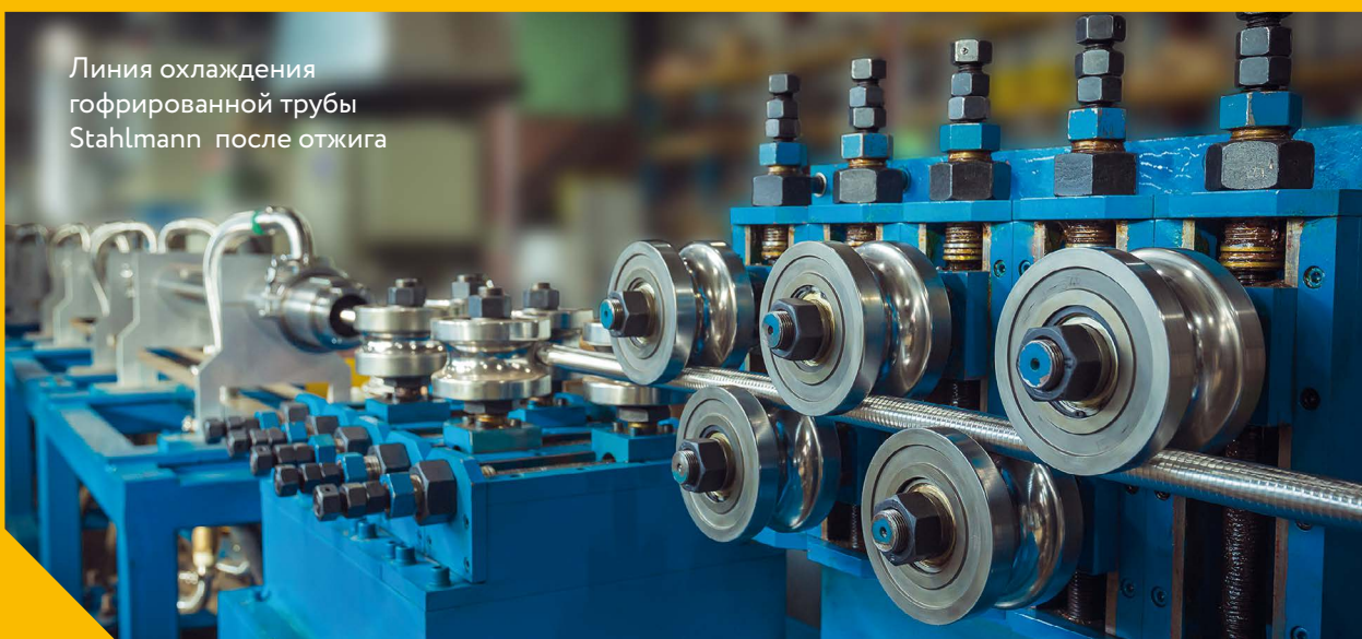
Контроль процесса отжига гофрированной трубы Stahlmann
