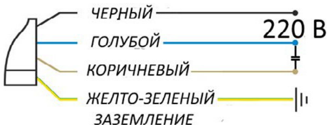
Рис.4 Подключение однофазного электродвигателя с выносным конденсатором
