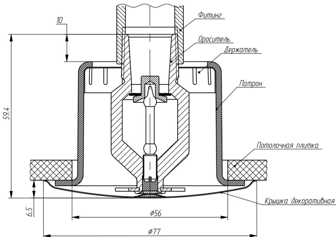
Рисунок 1 - Монтажная схема установки оросителя спринклерного скрытого
