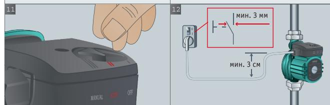
Установите переключатель в положение II (автоматический режим работы для моделей ZP)
