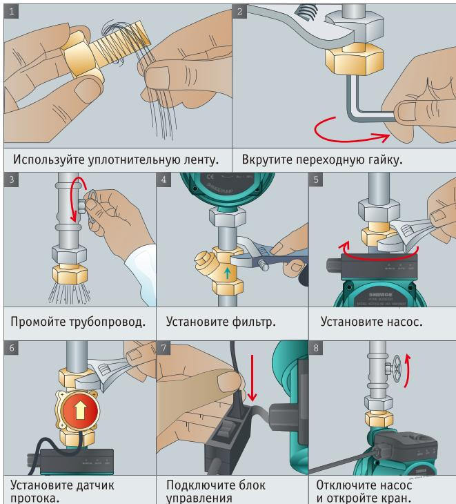
К перекачиванию допускается только «мягкая» вода (РН 6,5 – 8,5) без абразивных примесей и волокнистых включений. Перекачивание агрессивных и взрывоопасных жидкостей строго воспрещено.
