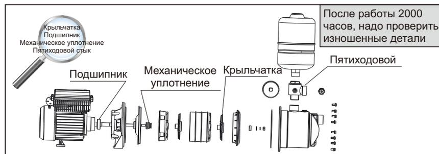
Испытание на герметичность: после демонтажа на ремонт или смены разных герметических деталей надо выполнить испытание на давление воды (атмосферы) несущих деталей и целой машины по максимальному рабочему давлению, в течение 3 минут нет утечки и пота.
