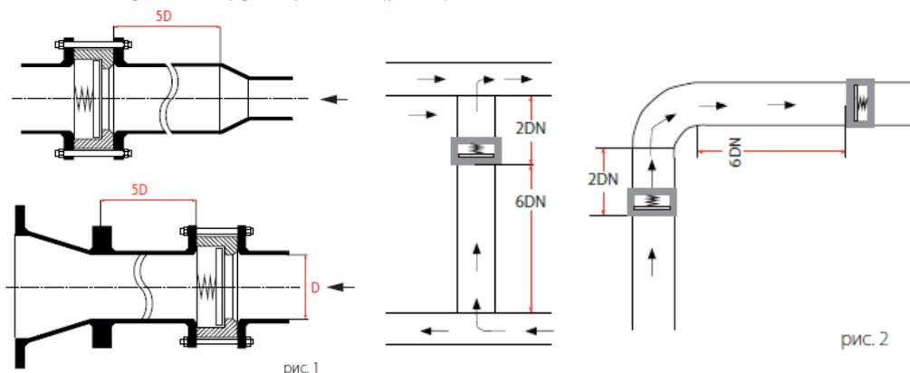
**ВНИМАНИЕ!** Предпочтительное монтажное положение на наклонном или вертикальном трубопроводе при направлении движения воды снизу-вверх.
