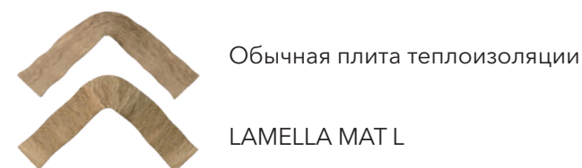
Рис. 8. Расположение волокон LAMELLA MAT L
