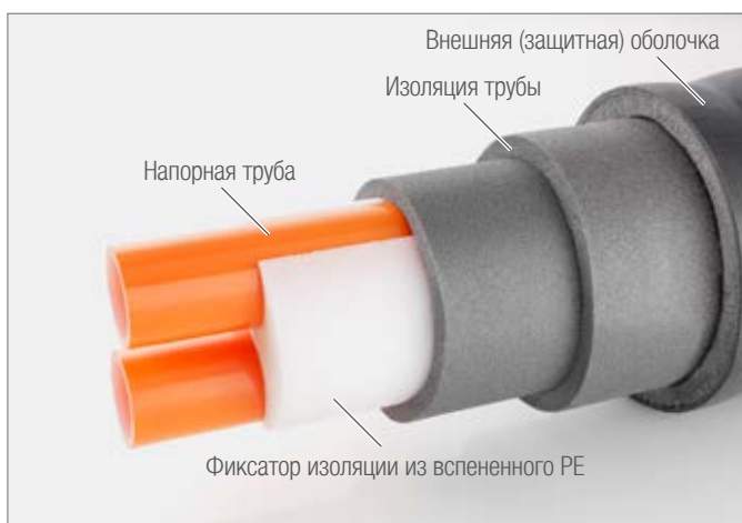
Рис. 3-12 Труба RAUVITHERM – основные составляющие части
