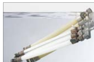
Рис. 3-7 Испытание на непроницаемость
