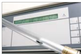
Рис. 3-6 Испытание на прочность при действии внутреннего давления
