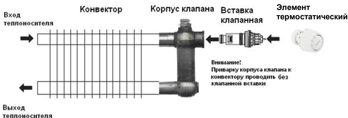
Рис. 4 – Схема монтажа терморегулятора системы отопления.
