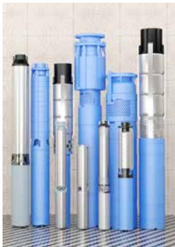
Агрегат электронасосный центробежный скважинный для воды (далее - агрегат) предназначен для подъема воды из скважин с общей минерализацией (сухой остаток) не более 1500 мг/л, с водородным показателем (рН) от 6,5 до 9,5, температурой до 35 °С, с массовой долей твердых механических примесей не более 0,01 % (100 г/м<sup>3</sup>), с содержанием хлоридов не более 350 мг/л, сульфатов не более 500 мг/л, сероводорода не более 1,5 мг/л для городского, промышленного и сельскохозяйственного водоснабжения.
