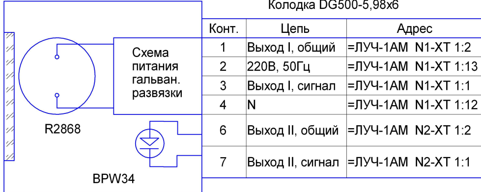
Рис.1. Фотодатчик ФД-05 ГМ. Схема электрическая принципиальная.
