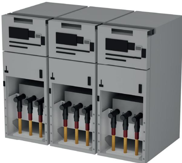
В настоящее время получили большое распространение РУ с газовой изоляцией. Такие РУ имеют очень компактные отсеки для подключения кабелей. Кабельные отсеки закрыты со всех сторон металлическими стенками, а значит, полностью экранированы. Для подключения кабелей применяются специальные адаптеры. Для закрытых кабельных отсеков применение экранированных адаптеров не требуется.
