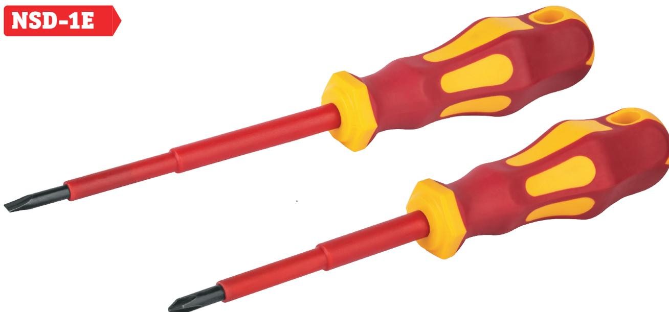
**Диэлектрические отвертки серии NSD** предназначены для работы в электрических сетях и силовых токопроводящих точках, находящихся под напряжением до 1000 В. Отвертки соответствуют требованиям по безопасности, прочности и защите окружающей среды. В процессе производства, изоляция каждой отвертки проходит тестирование на пробой напряжением 10 000 В в течение 10 секунд.
