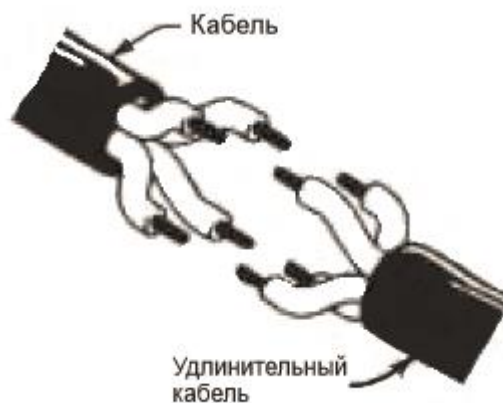
Рис. 7 Если необходимо удлинить кабель, используйте удлинительный кабель с большим размером сердечника, что и у кабеля, поставляемого с насосом
