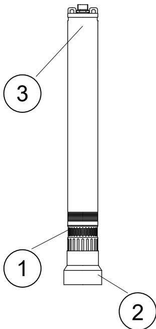
Насосы ECO AUTOMAT представляют собой центробежные моноблочные многоступенчатые насосы с корпусом из нержавеющей стали.
