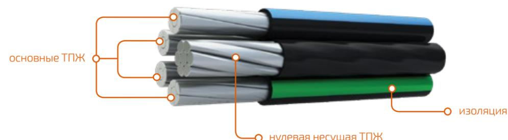
Провод самонесущий с алюминиевыми фазными токопроводящими жилами и несущей жилой из сплава алюминия, все жилы изолированы светостабилизированным сшитым полиэтиленом (ПЭ).
