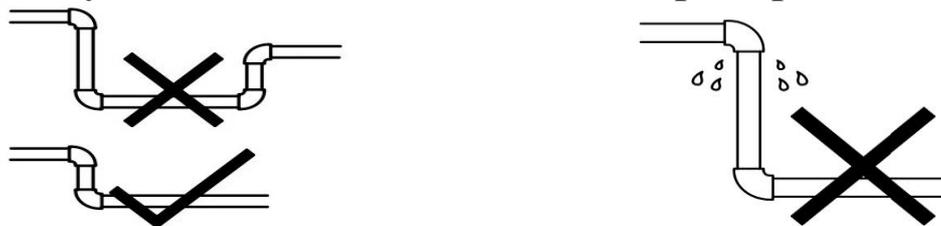
5. Если мини-станция будет использоваться для перекачивания жидкости из водоемов, то на входном трубопроводе необходимо установить обратный клапан и фильтр (не входят в комплект поставки). Обратный клапан необходимо располагать вертикально на расстоянии не менее 50 см от дна, для предотвращения всасывания донных отложений, песка и глины (смотрите рисунки ниже).
